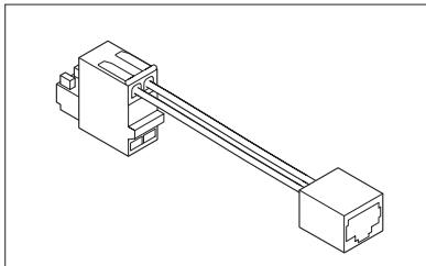
4. 1 Ethernet-kabel, t.ex. Cat5/Cat6 med extern skärm, för att ansluta laddstationen till energimätaren (medföljer ej kitet).
