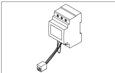
3. 1 adapterkabel voor het bedieningspaneel met vrouwelijke RJ45-aansluiting.
