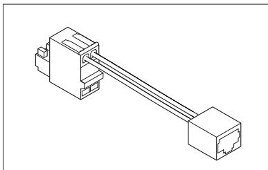
4. 1 ethernetkabel, bijvoorbeeld Cat5/Cat6 met externe afscherming, om het laadstation aan te sluiten op de elektriciteitsmeter (niet meegeleverd in de set).
