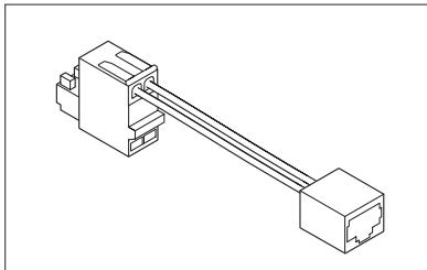
4. 1 Ethernet-kabel, for eksempel Cat5/Cat6 med eksternt skjold, for å koble ladestasjonen til strømmåleren (ikke inkludert i settet).
